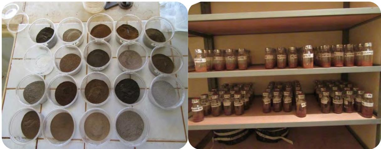
*Photo 2: Etat des matières fertilisantes après séchage et broyage (à gauche) et disposition des microcosmes dans la salle d'incubation pour les mesures de la respirométrie (à droite), Laboratoire des Radio Isotopes 2018.*
