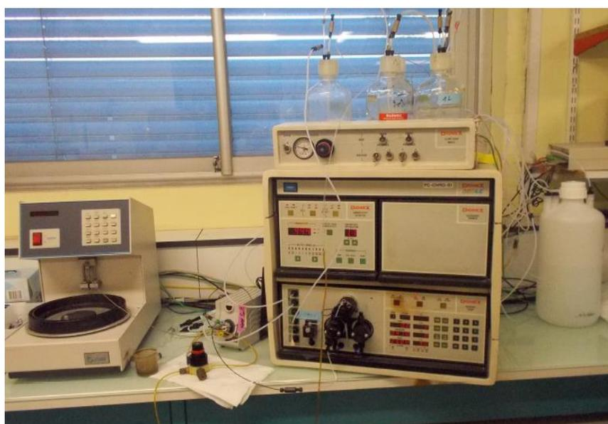
**Figure 44** : Chromatographie ionique haute pression (HPiC)
