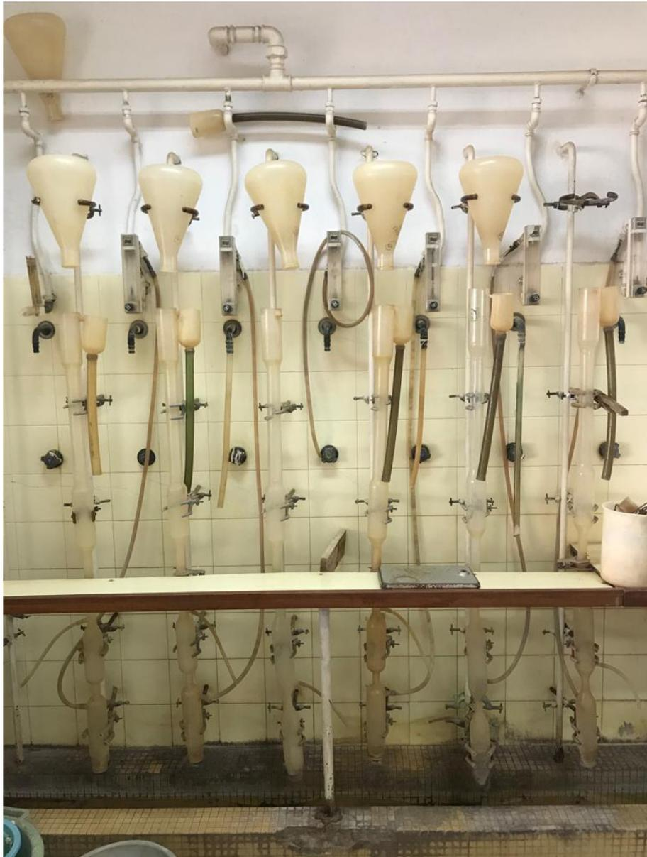
**Figure 16** : Dispositif de Seinhorst permettant l'extraction des nématodes du sol
