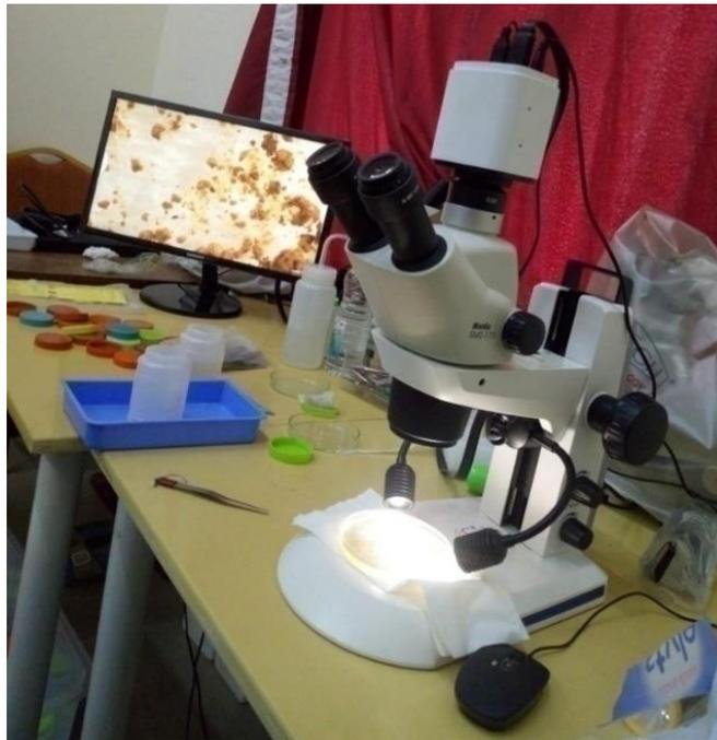
**Figure 19** : Loupe binoculaire (ZEISS Motic SMZ-171) utilisée pour l'identification de la macrofaune du sol
