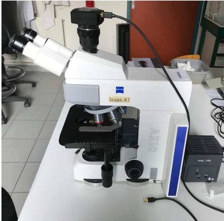
**Figure 20** : Microscope modulaire (Axio Scope A1 ZEISS) utilisé pour l'identification des collemboles
