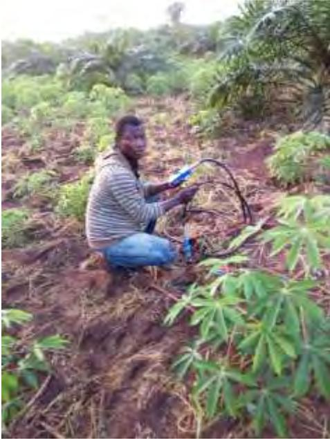
Mesure d'humidité à 4,5 m de l'arbre
