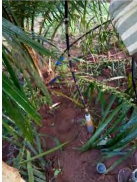
Mesure d'humidité à 1 m de l'arbre
